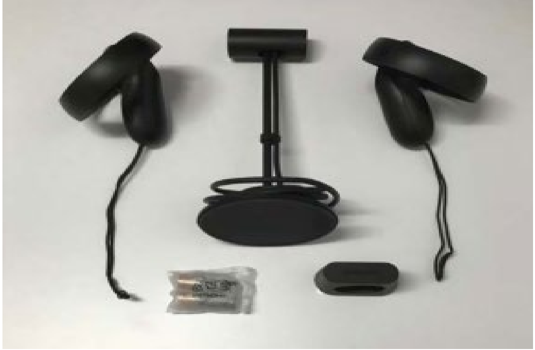
Görsel 4. SG setinin diğer donanımları (sensörler -Kontrolörler-pil-adaptör) Son aşama olarak gerekli vr yazılımının kurulumunu yaparak vr donanımını hazırlamış olur.
